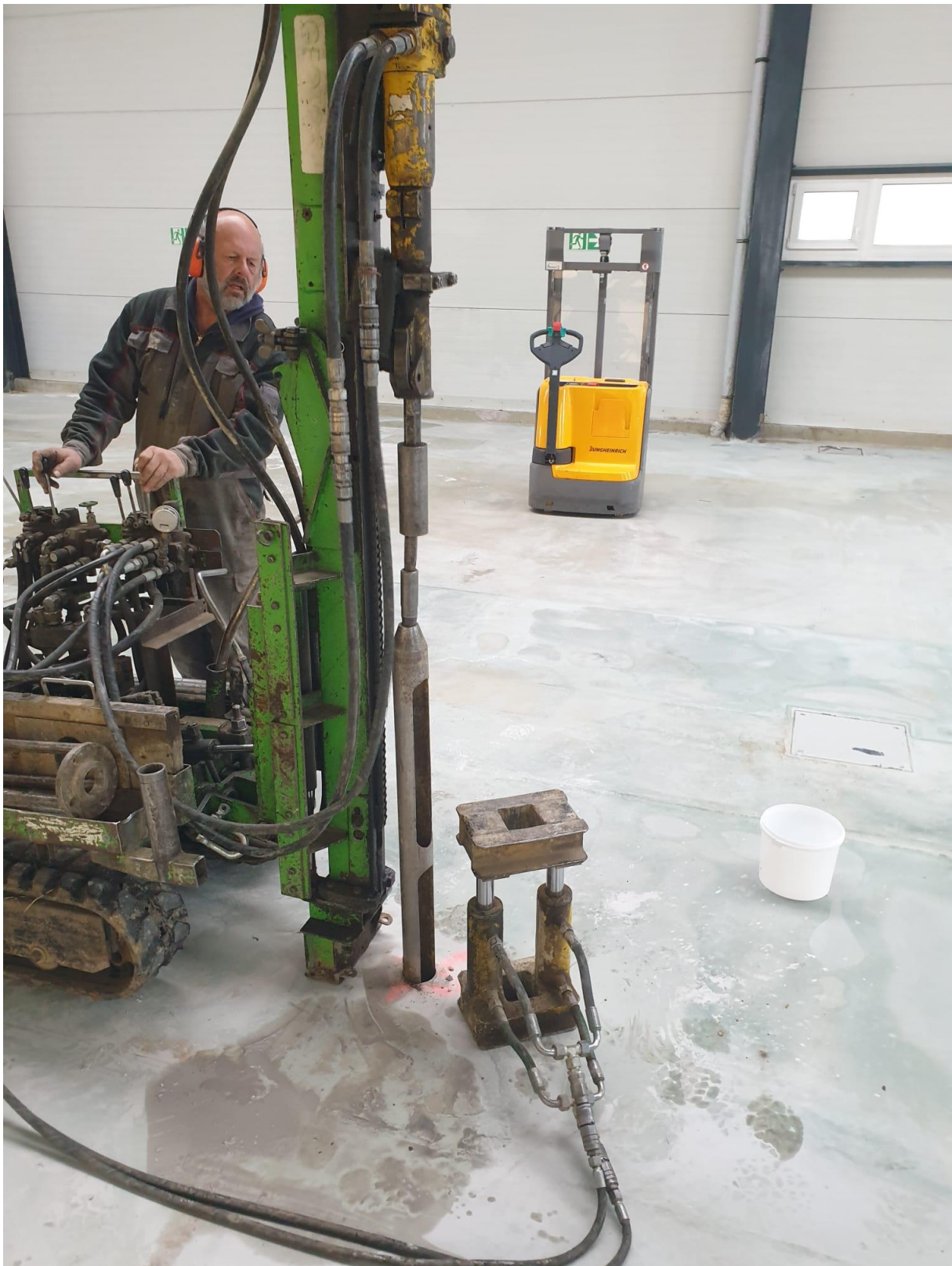
Abb. 32.: Ramkernsondierung an P6.2
