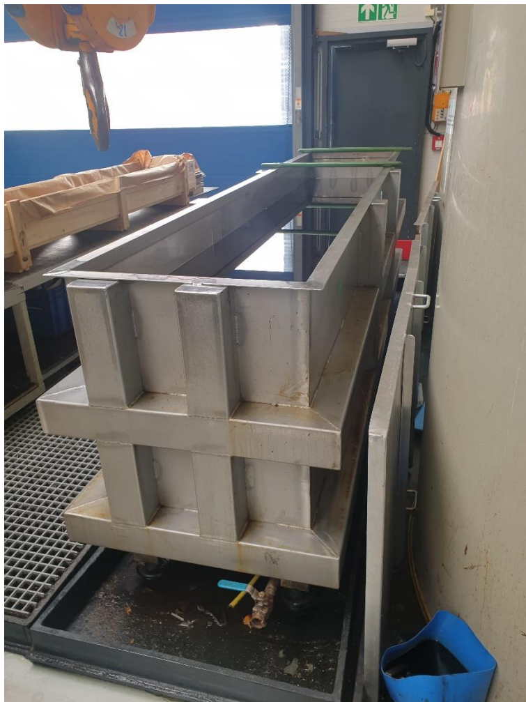
Abb. 10: Ölbad für fertiges Produkt, \approx 125 l Öl / a Verbrauch
