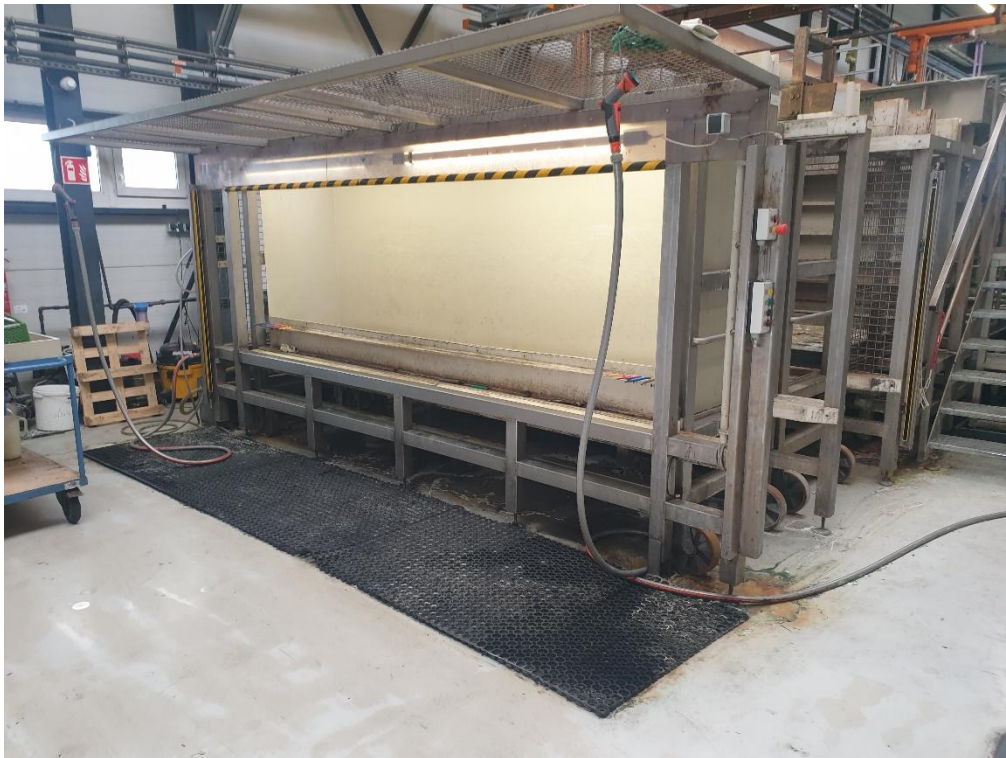
Abb. 11: Abbrausen fertiges Produkt, Chromreste rausspülen vor dem Ölen mit VE-Wasser (destilliert)
